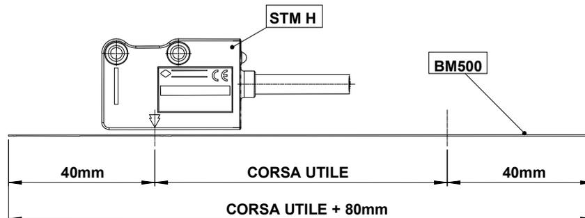
**IMPORTANTE:** per non compromettere la precisione del sistema, la Banda Magnetica BM500 deve essere più lunga della corsa della macchina di almeno 40 mm per parte.
